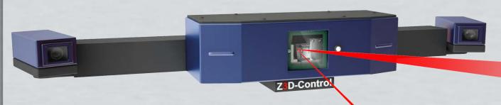
Die technische Basis bilden ein Laserprojektions- und Stereokamerasystem, sowie ein umfangreiches Softwarepaket, das explizit für standardisierte Messungen und Projektionen in den verschiedensten Industrien entwickelt wurde.
